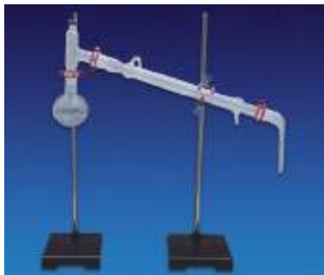
1 | Fabricado en vidrio borosilicato con uniones esmeriladas 29/32.
